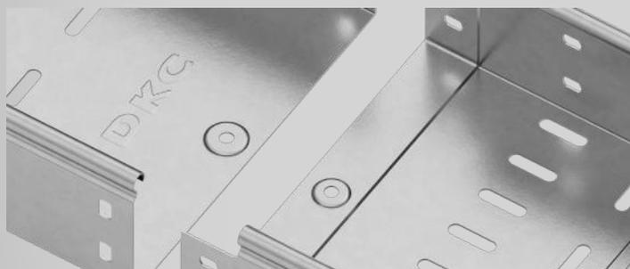
La presenza di una bordatura continua sui fianchi (bordi) sia delle basi che dei coperchi garantisce una maggiore tenuta ai carichi e consente l'assemblaggio di tutti i coperchi del sistema senza ricorso a viti o clip.
