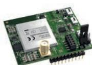
*XMULTICOM, equipaggiato con un dispositivo XWBL o XMB, permette di comandare automazioni compatibili dotate di XRS485 ed automazioni generiche (es. azionamento luci, impianto di irrigazione, etc.)*
