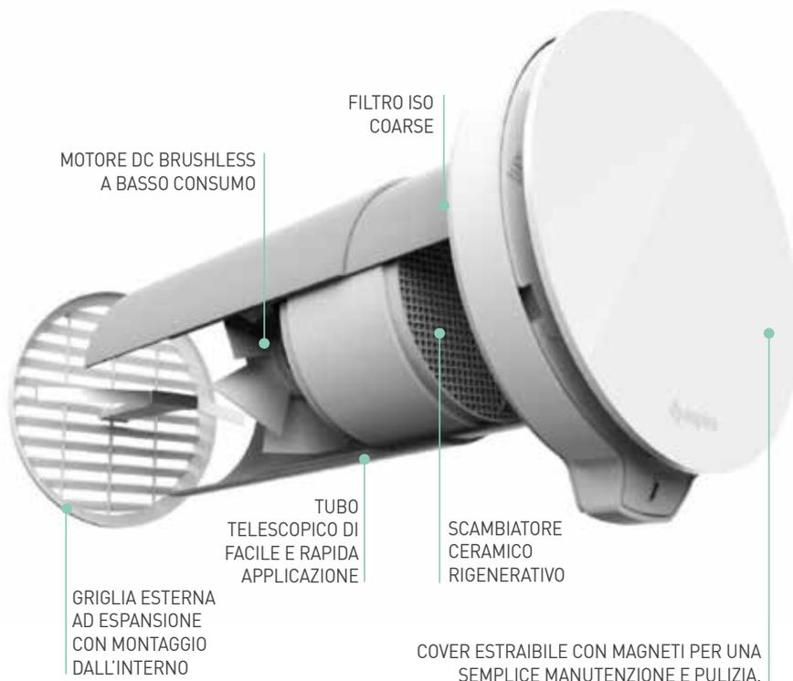
L'aria viene costantemente filtrata attraverso un filtro "ISO Coarse" installato sul frontale dell'apparecchio e facilmente estraibile al fine di consentirne una pulizia periodica.
