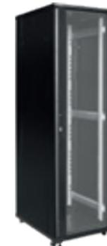
Armadio RACK standard 19" da pavimento, 42U già assemblato include porta anteriore/posteriore, pannelli laterali, 4 ruote e 4 piedini livellatori. Dimensioni (LxAxP) 600x2055x800 mm (72 mm distanza dal pavimento). Colore nero RAL9004.
