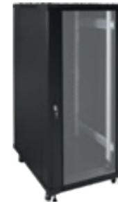
Armadio RACK standard 19" da pavimento, 27U già assemblato include porta anteriore/posteriore, pannelli laterali, 4 ruote e 4 piedini livellatori. Dimensioni (LxAxP) 600x1388x800 mm (72 mm distanza dal pavimento). Colore nero RAL9004.
