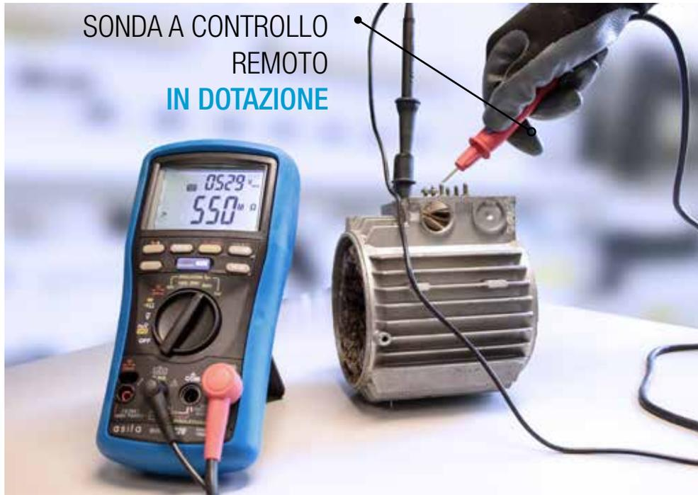
MI720 non è solo un prova continuità del conduttore di protezione e misuratore della resistenza di isolamento, ma contiene anche le funzioni di multimetro professionale: meno strumenti da portare nella cassetta e nel furgone, meno possibilità di perderli!
