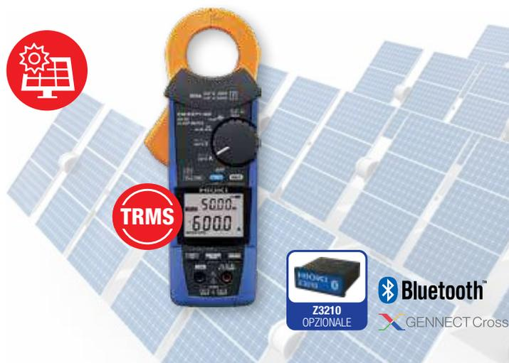
Analizzatore amperometrico multifunzione compatto e robusto. La temperatura di lavoro estremamente ampia, spazia dai +65°C ai -25°C grazie all'altissima qualità dei componenti. Può misurare la corrente prodotta dalla stringa e contemporaneamente la tensione in uscita per visualizzarne il prodotto (VA) senza interrompere l'anello, utilizzando il kit di terminali opzionali modello PV/KIT/VA.
