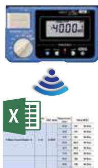
Aprire il file Excel e selezionare una cella. Il valore bloccato sul display dello strumento verrà trasferito sul computer in corrispondenza della cella selezionata.
