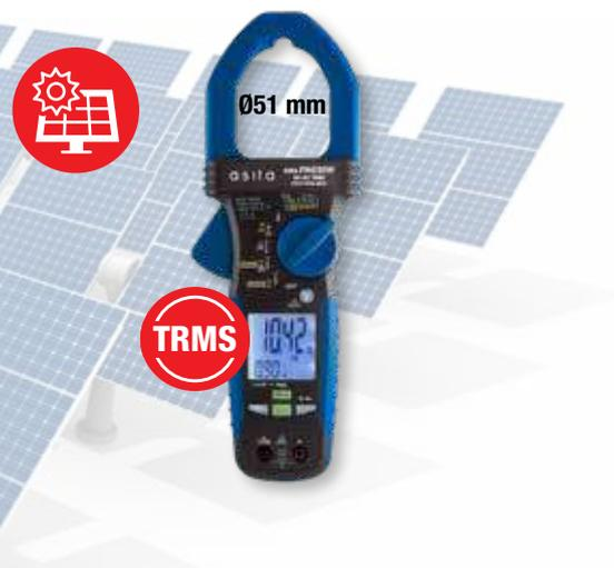
DURA PA630W è un nuovo wattmetro a pinza per la misura della potenza in corrente alternata AC e in continua DC fino a 1000A e 1000V in Vero Valore Efficace TRMS. Misura la potenza di un circuito monofase e di un circuito trifase equilibrato calcolando anche la potenza di un circuito trifase non equilibrato.
