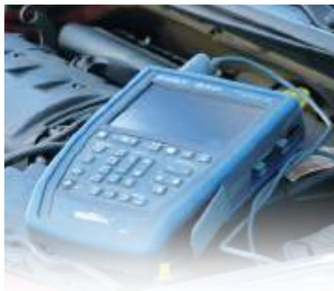
La funzione **BUS** degli strumenti **SCOPIX IV** consente di eseguire le misure elettriche necessarie per valutare l'integrità dei bus di campo, ovvero il funzionamento dello strato fisico (specifiche elettriche, sincronizzazione, ecc.), secondo le norme vigenti.
