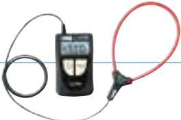
Misurazione dell'intensità di corrente
