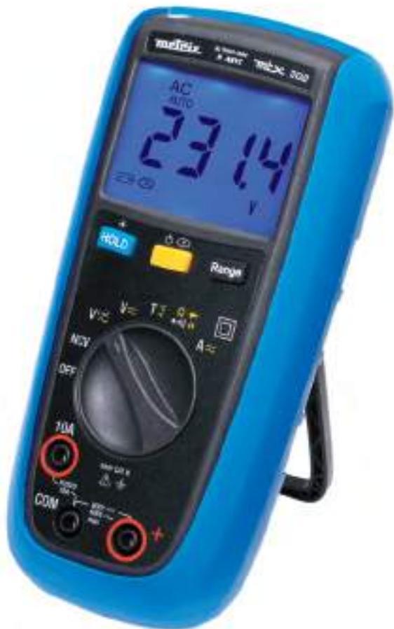
**Una gamma semplice e intuitiva composta da 2 multimetri TRMS AC e 1 multimetro TRMS AC+DC con display digitale. Progettati per misurare le reti elettriche su impianti fino a 600 V CAT III, questi multimetri sono dispositivi professionali adatti a un uso generico. In virtù dell'estrema robustezza e affidabilità, sono lo strumento ideale da portare sul campo e si prestano alle applicazioni quotidiane che richiedono misure TRMS e risultati precisi.**
