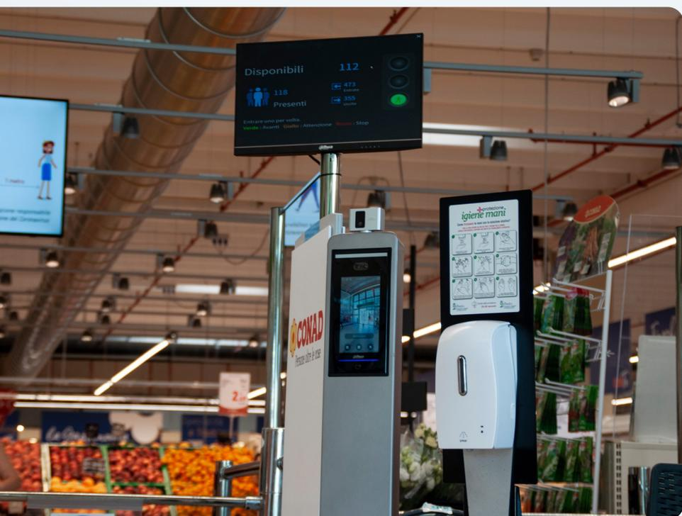
In caso contrario il sistema non sblocca il tornello, riproduce un messaggio vocale e invia subito un segnale di allarme al personale. Sono strumenti più sicuri, rapidi ed efficaci rispetto all'impiego di addetti alla misurazione della temperatura con un termometro manuale, che causa inevitabilmente rallentamenti, innalzamento dei costi e maggiori rischi di contagio.
