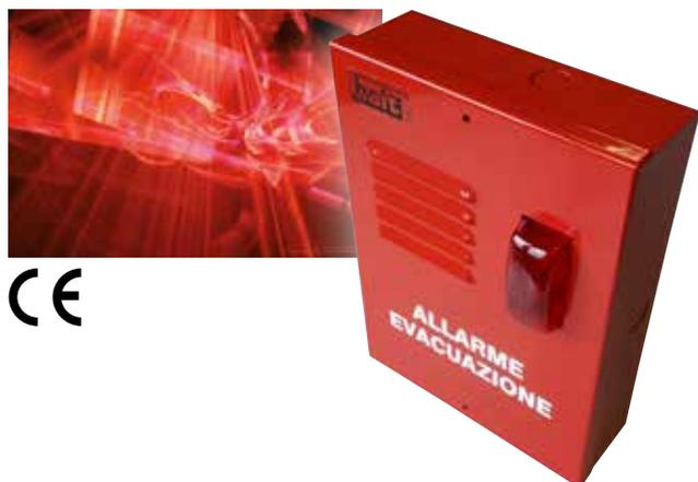
Unità ottico acustica per segnalazione evacuazione, autoalimentata, alimentazione, 13.8 Vdc, ingressi allertamento, evacuazione e reset, illuminazione led alta luminosità, calotta policarbonato rossa, struttura lamiera elettrozincata, colore rosso RAL 3000, grado di protezione IP 31, ingressi programmabili (solo in modalità stand alone).
