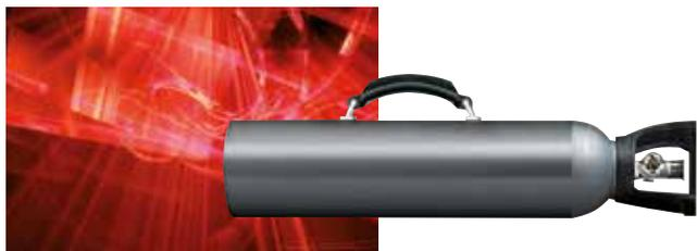
Per fare un ottimo collaudo si devono usare bombolette precalibrate. Si devono usare anche per non guastare le capsule di rilevamento gas.
