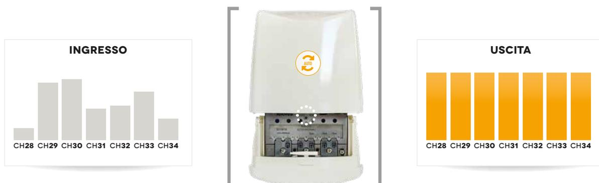
*\*Il pulsante di autoprogrammazione è disponibile sul telaio di tutti gli amplificatori, e anche nell'alimentatore domestico incluso con la versione amplificatore da palo (esterno).*
