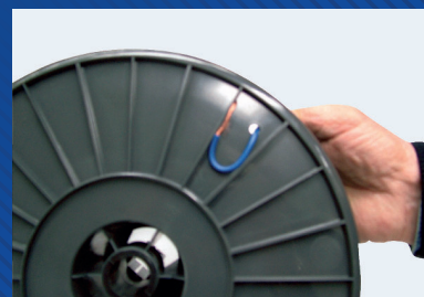
Sotto il cestello piegare il filo o fare un piccolo nodo Bend or tie the wire under the coil holder
