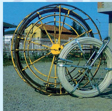
◀ Foto storica. Installazione in cavidotto stradale di una sonda in fibra di vetro. Historic photo. Installation of a glassfiber fishtape in a road conduit.
