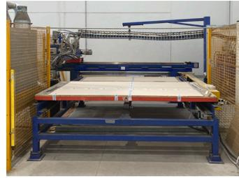
Macchina Schiumatrice automatica, una delle ultime new entry, utilizzata per la creazione di Rack o soluzioni con grado di tenuta IPxx. Permette la creazione di lavori precisi e sicuri in poco tempo.
