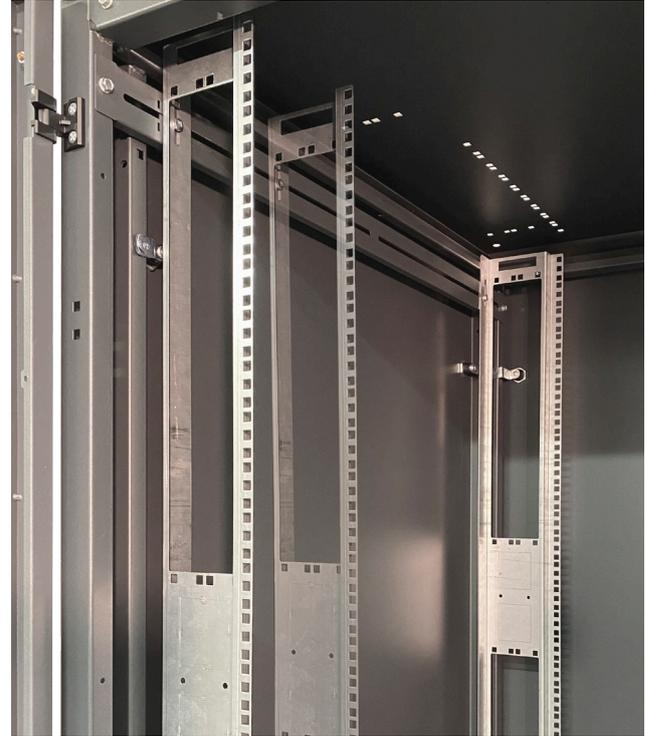
Montanti anteriori e posteriori in lamiera zincata con spessore 20/10. Regolabili in profondità senza alcun passo fisso tramite traverse fissate alla struttura.
