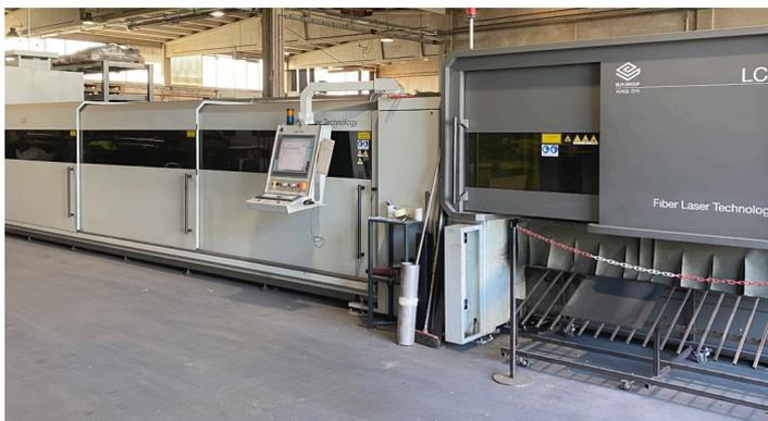
Una delle più recenti integrazioni, la macchina per il taglio fiber laser di ultima generazione con carico e scarico automatico. Taglio tubi con carico di verghe fino a 6 metri.
