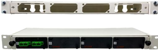
Box ottico profondo 130mm adatto per armadi QDSA (NON utilizzabile in orizzontale nel QDSA-I ad incasso). Predisposti alloggiamenti per 4 moduli ed entrata cavi posteriore. Colorazione RAL 9010 finitura liscia. Utilizzabili moduli ottici e modulo per connettori rame.
