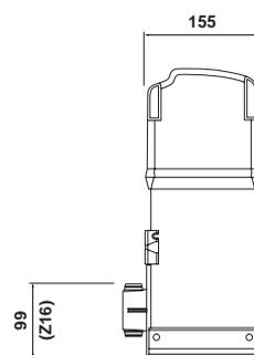
Cremagliera zincata 30x8 mod. 4 attacchi fissaggio mecc. inclusi (conf. 4 pezzi da 1m)
