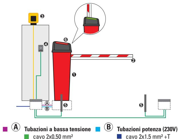
ATTENZIONE: La configurazione può essere modificata in funzione della "analisi dei rischi" specifica di ogni installazione (Rif. Norme Europee UNI-EN 12445 e 12453). Dal costo indicato sono escluse le spese per l'installazione e per la predisposizione di opere murarie, elettriche e fabbriili.
