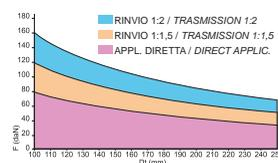
Per valutare la corretta applicazione dell'automazione rilevare la forza necessaria per sollevare la porta (valore rilevabile anche sulla documentazione della porta stessa) e il diametro del tamburo avvolgifuni. Il grafico consentirà di determinare la possibile applicazione del motoriduttore e la necessità di utilizzo di un kit rinvio applicazione fuori asse (vedere accessori).
